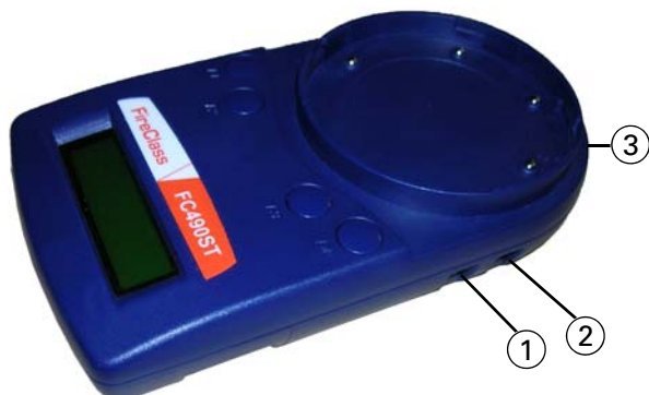
Fig. 1: Herramienta de servicio para bucle FC490ST 1- \mu P (no se utiliza) 2- Conector para PC (no se utiliza) 3- Conector AUX
