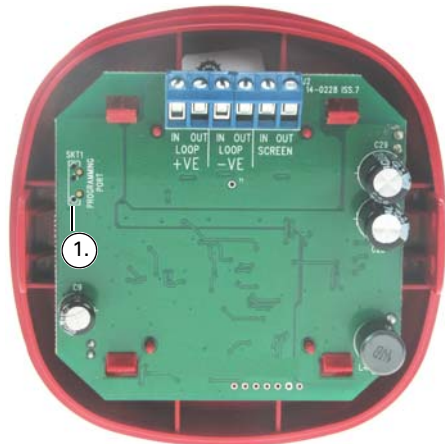
Fig. 4: Porta di programmazione 1 – Porta di programmazione
