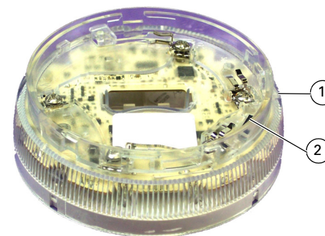
Fig. 1: Vista generale della base sirena/lampeggiatore EN54-23 Open Class—FC430LPBSB LP 1– Il dispositivo di blocco si inserisce qui 2– Porta di programmazione
