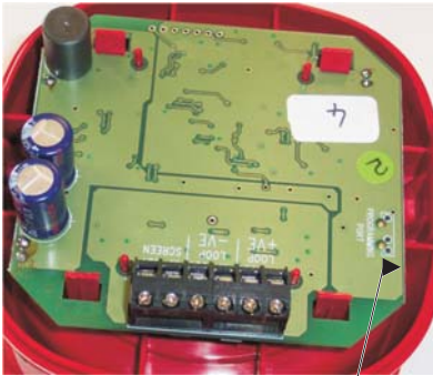
Fig. 3 Programmieranschluss. FC410LP Series Programming Port. Porta di Programmazione della serie FC410LP.
