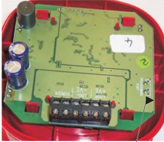
Fig. 3 Puerto de programación de la Serie FC410LP. Porta de programação da série FC410LP.
