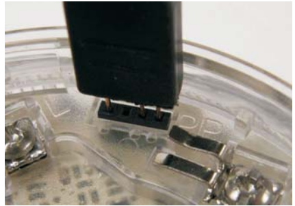
Fig. 4 Cable de programación del FC490ST y Puerto de programación del FC340LP. Conector de programação FC490ST e interface com porta de programação FC430LP.
