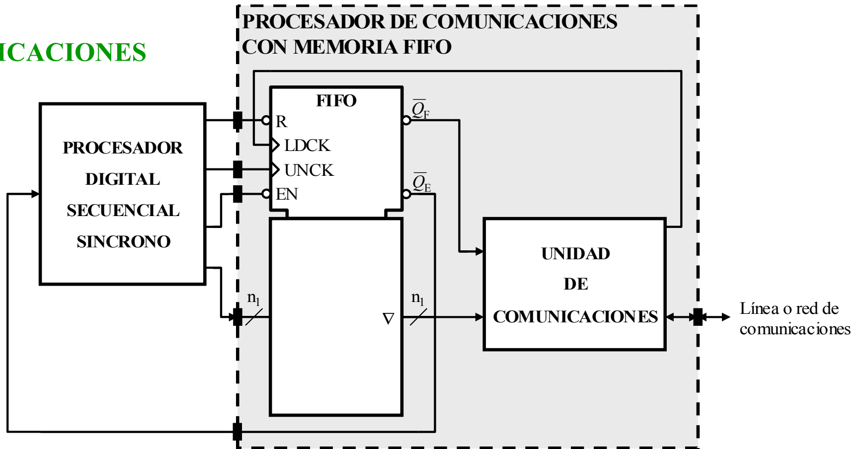
Esquema de bloques de un procesador de comunicaciones implementado con una memoria cola
