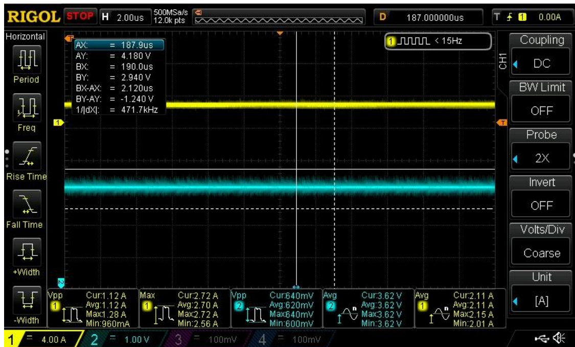
Figura 7.20: Formas de onda obtenidas con el osciloscopio para una salida de 3,3V a 2 A (2)
