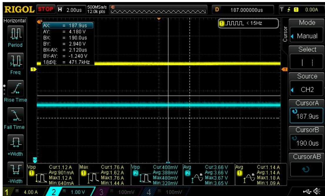
Figura 7.19: Formas de onda obtenidas con el osciloscopio para una salida de 3,3V a 1 A (2)
