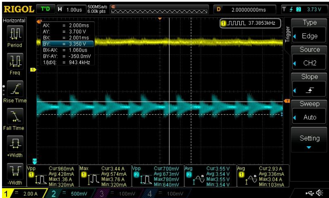
Figura 7.22: Formas de onda obtenidas con el osciloscopio para una salida de 3,3V a 3 A (2)
