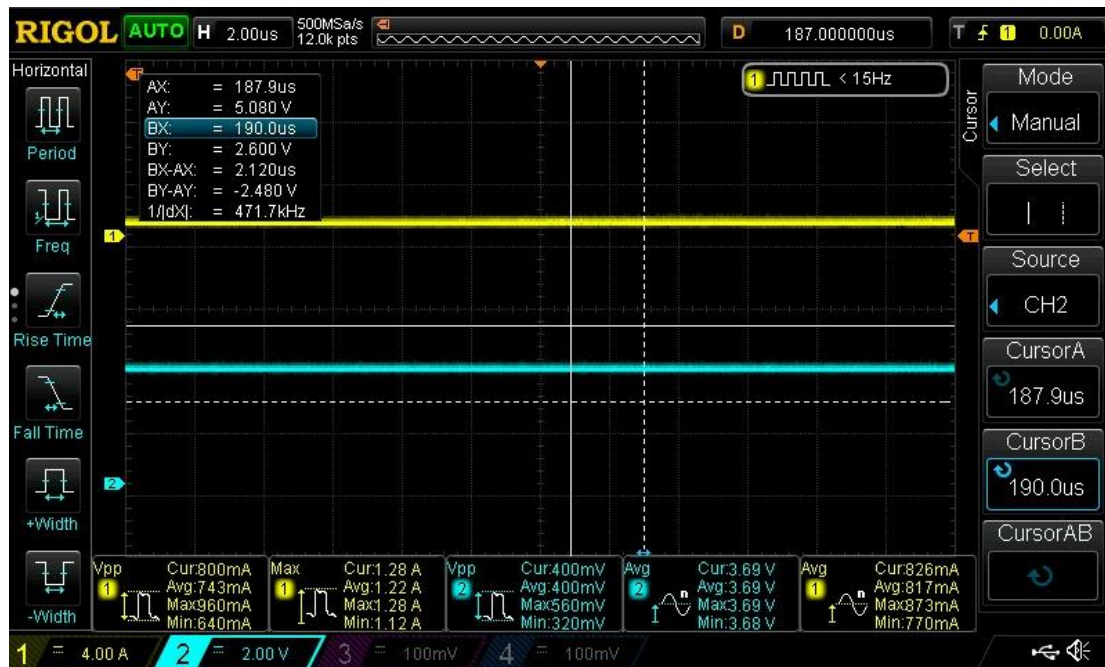
Figura 7.18: Formas de onda obtenidas con el osciloscopio para una salida de 3,3V a carga nominal (2)
