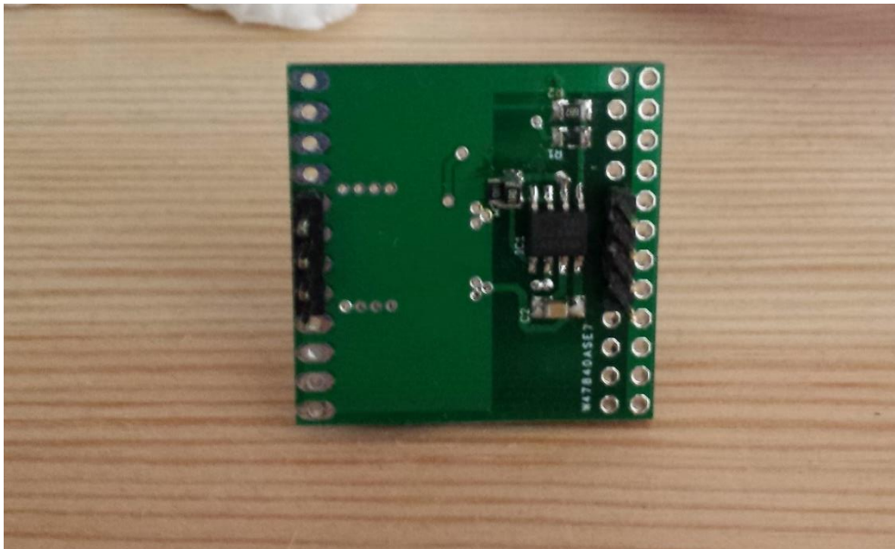
Figura 5.14: Montaje final del buck ajustable basado en el integrado MC34063A (trasera)
