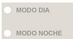
La señalización del modo de trabajo actual se realiza a través de los indicadores luminosos 'MODO DÍA' y 'MODO NOCHE' situados en la parte superior izquierda de la central. Cuando ambos indicadores están apagados la central trabaja en modo COMPLETO.
