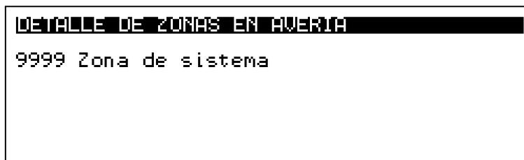
A la zona de sistema no se le pueden asignar ni sinópticos ni secuencia automática, ni puede formar parte de una condición de disparo.
