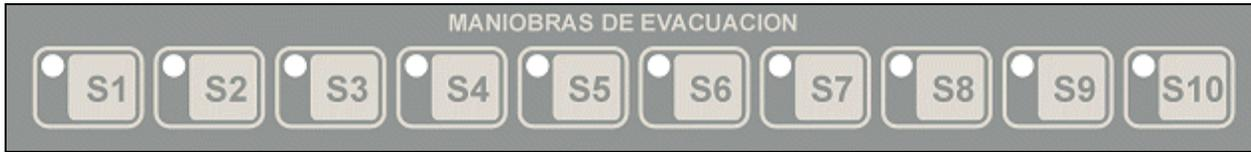
Estas teclas incluyen un indicador luminoso que se activará de modo intermitente durante el proceso de activación, y continuo una vez terminado el proceso.
