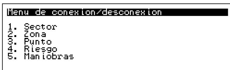
Para poder desconectar un elemento de la instalación, este debe haber sido previamente conectado. Por defecto, todos los puntos de la instalación están en estado conectado, a no ser que su modo de funcionamiento no corresponda con el que se encuentre la Central (Día/Noche).
