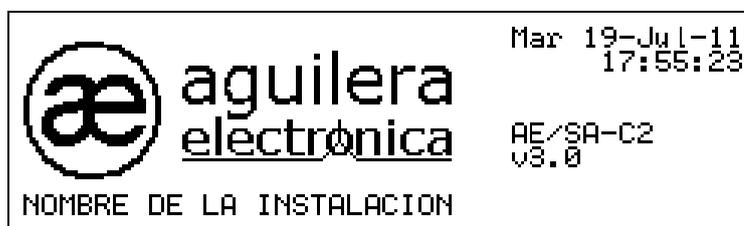
En la parte derecha se muestra la fecha y hora de la Central, y un poco más abajo el modelo de la Central y la versión del software.
