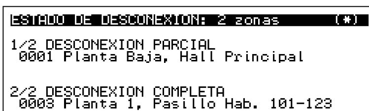
Con el fin de señalar que, alguno de los puntos desconectados se encuentra en estado de alarma en el momento de la consulta, al mostrar la presentación de las zonas desconectadas, se muestra en la línea superior un asterisco parpadeando.
