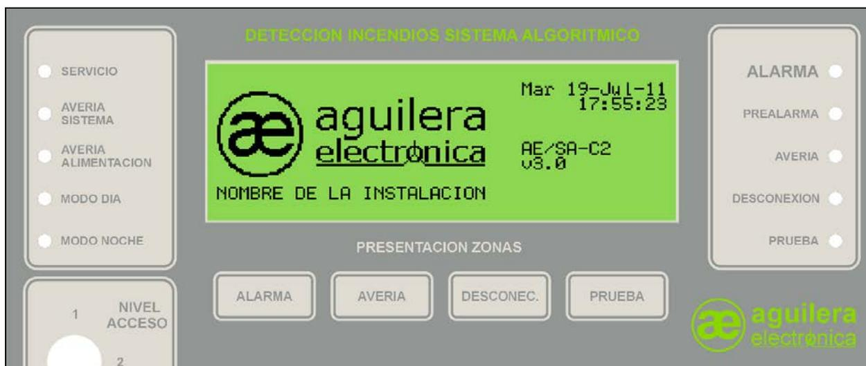
Cuando la Central se inicia en este modo, se desconectan automáticamente las secuencias y los relés locales de forma que la Central no lleva a cabo ninguna maniobra, independientemente del estado de la instalación.
