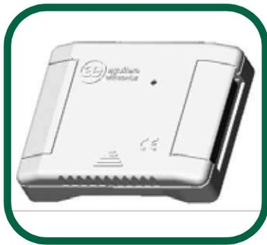
El módulo aislador bidireccional AE/SA-AB permite controlar y aislar cortocircuitos en el bucle de detección algorítmico, dejando fuera de servicio la zona afectada entre 2 aisladores para instalaciones realizadas en bucle cerrado, o la que dependa de dicho aislador para instalaciones en lazos abiertos.
