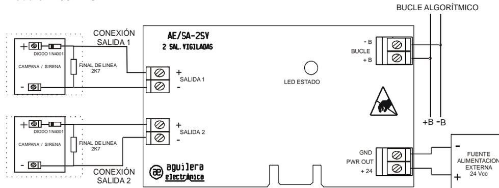
Este módulo requiere tensión de alimentación auxiliar de 24 Vcc para la actuación de las salidas.
