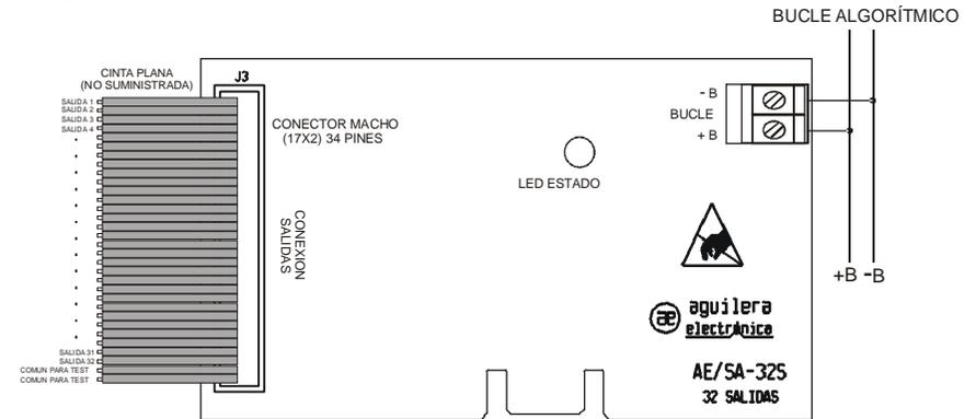
El módulo AE/SA-32S dispone para la conexión de las mismas un conector macho de cinta plana de 17X2 pines. Los pines 33 y 34 sirven, cuando se ponen a negativo, para realizar un test global del resto de las salidas.
