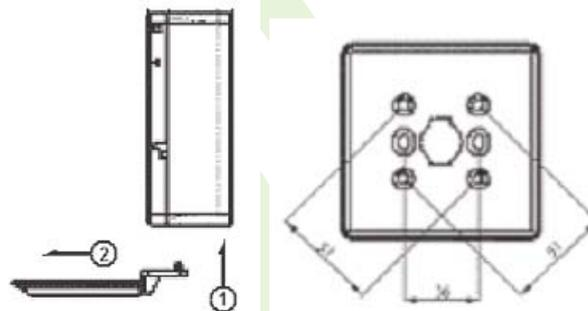
Para su instalación, fijar la caja del pulsador a la pared mediante 2 tornillos utilizando los orificios de sujeción previstos para tal fin, introduciendo los cables de conexión por el orificio situado en la parte central de la caja. Antes de instalar el pulsador es necesaria su codificación como se indica en la última página.
