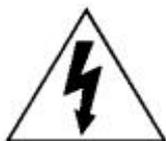
Este símbolo refere-se a um alerta ao usuário quanto a falta de isolamento interno do aparelho que poderá causar magnitude suficiente para constituir um risco de choque elétrico à pessoa que abrí-lo.
