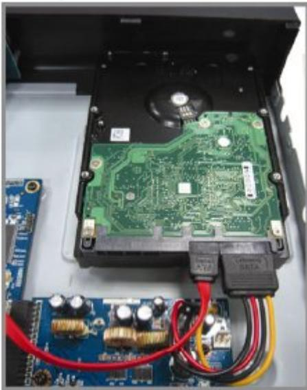
Passo 4: Alinhe os lados a parafusar do suporte de HD com os furos do HD antes de parafusar, conforme mostrado abaixo. Então, fixe o HD no suporte com o parafuso adequado.
