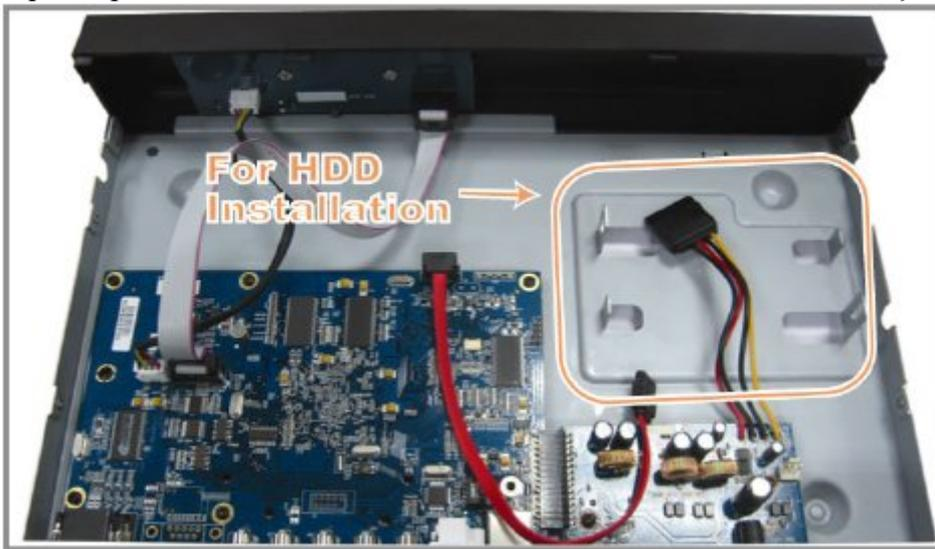
Passo 2: Obtenha HD's compatíveis e conecte os cabos de alimentação e dados.
