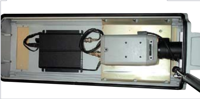
Carcasa con cámara analógica y servidor de vídeo instalados
