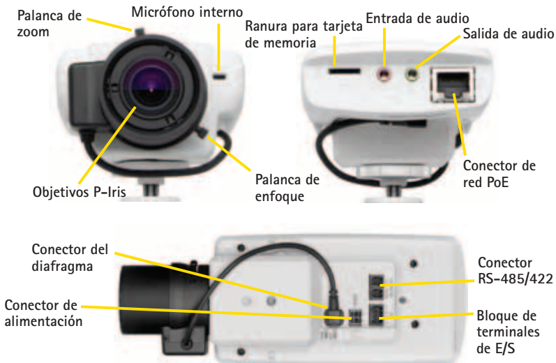
Figura 2.1b Vista frontal, posterior e inferior de una cámara de red.
