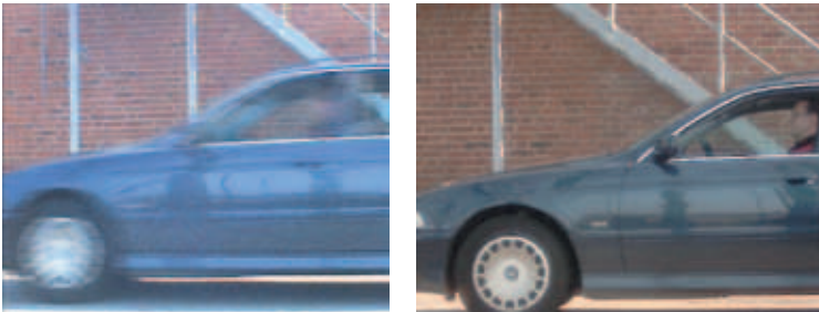
Figura 3.5b A la izquierda, una imagen JPEG a tamaño completo (704x576 píxeles) procedente de una cámara analógica que utiliza barrido entrelazado. A la derecha, una imagen JPEG a tamaño completo (640x480 píxeles) procedente de una cámara de red Axis que emplea tecnología de barrido progresivo. Ambas cámaras emplearon el mismo tipo de objetivos y la velocidad del vehículo era la misma a 20 km/h (15 mph). El fondo resulta claro en ambas imágenes. Sin embargo, al conductor solo se le aprecia claramente en la imagen que emplea tecnología de barrido progresivo.
