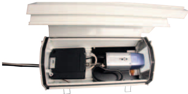
Figura 4.2b Ilustración del posible posicionamiento de un codificador de vídeo de un canal junto a una cámara analógica en una carcasa de cámara.
