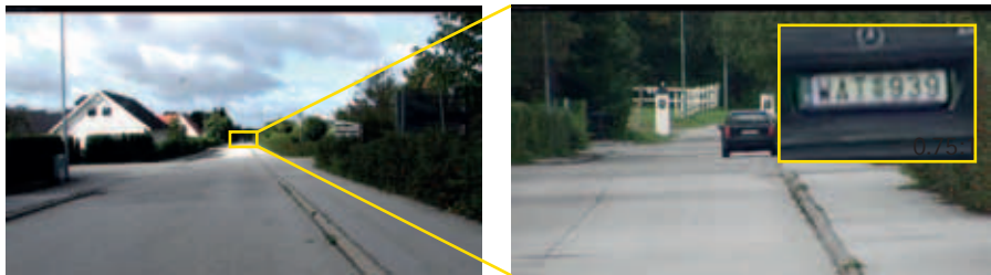
Figura 2.4j A la izquierda, vista panorámica y a la derecha, vista ampliada con un factor de zoom \times 20 y una domo PTZ HDTV 1080p, que permite la lectura de la matrícula situada a una distancia de 275 m de la cámara.
