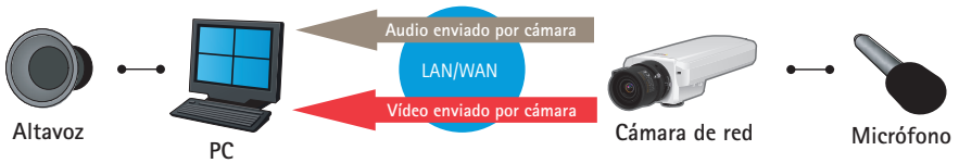
Figura 8.3a En modo simplex, solo se envía audio en una dirección. En este caso, la cámara envía el sonido al operador. Las aplicaciones incluyen supervisión remota y videovigilancia.
