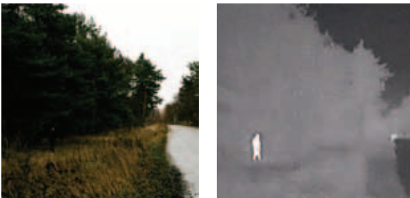
Figura 2.2e A la izquierda, imagen procedente de una cámara convencional. A la derecha, imagen procedente de una cámara térmica.
