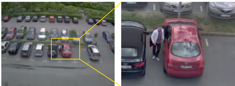
Figura 2.4d A la izquierda, una imagen de 5 megapíxeles reducida. A la derecha, la aplicación AXIS Digital Autotracking proporciona una vista VGA cortada sin pérdida de calidad de imagen del área en la que se produce la actividad.
