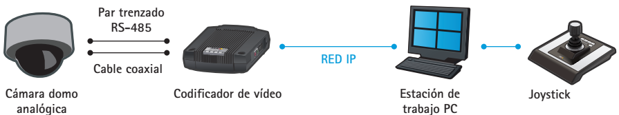
Figura 4.4a Una cámara domo PTZ analógica puede controlarse a través del puerto serie del codificador de vídeo (por ejemplo, RS-485), permitiendo su control remoto a través de una red IP.
