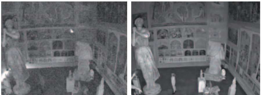
Figura 2.2b A la izquierda, imagen en Modo nocturno sin utilizar iluminadores IR (la cámara usa la pequeña cantidad de luz procedente de la parte inferior de la puerta, situada en la esquina izquierda de la estancia). A la derecha, imagen en Modo nocturno con iluminadores IR.
