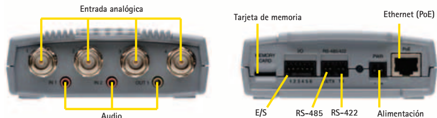
Figura 4.1b Un codificador de vídeo autónomo de cuatro canales con puertos de audio, E/S (entrada/salida) para controlar dispositivos externos como sensores y alarmas; puertos serie (RS-422/RS-485) para el control de cámaras analógicas PTZ, conexión a Ethernet compatible con Alimentación a través de Ethernet y una ranura para tarjetas de memoria que permite el almacenamiento local de grabaciones.
