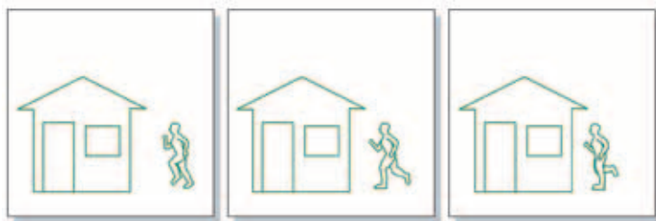
Figura 7.1a Mediante el formato Motion JPEG, las tres imágenes de la secuencia superior se codifican y envían como imágenes únicas independientes (fotogramas I), sin existir dependencias entre ellas.
