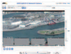
Figura 2.4l Mediante la máscara de privacidad integrada (rectángulos grises en la imagen), la cámara puede garantizar la privacidad en áreas que no deben incluirse en la aplicación de vigilancia.
