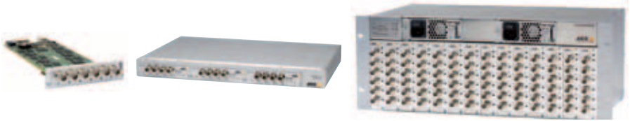
Figura 4.3a Codificador de vídeo en tarjeta y rack que ofrecen soporte a varias cámaras analógicas y características. Cuando un rack AXIS Q7900 (en el extremo derecho) está completamente equipado con codificadores de vídeo en tarjeta de 6 canales, tiene capacidad para conectar hasta 84 cámaras analógicas.
