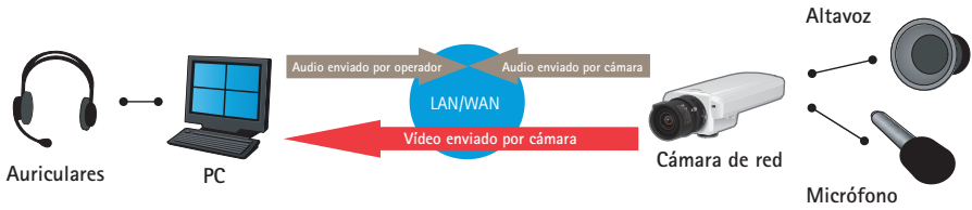
Figura 8.3c En el modo semidúplex, el audio se envía en ambos sentidos, pero por turnos. De modo similar al funcionamiento de un walkie-talkie.
