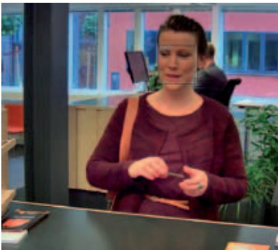
Figura 2.3c El contador de píxeles Axis es una ayuda visual con forma de marco y un contador correspondiente que muestra el ancho y la altura de la caja. El contador de píxeles ayuda a verificar, por ejemplo, si la resolución de píxeles de una cara es suficiente para realizar una identificación facial.
