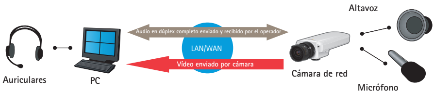
Figura 8.3d En modo dúplex completo, el audio se envía a y desde el operador simultáneamente. Este modo de comunicación es similar a la empleada en una conversación telefónica. El dúplex completo requiere que el PC cliente disponga de tarjeta de sonido compatible con audio dúplex completo.
