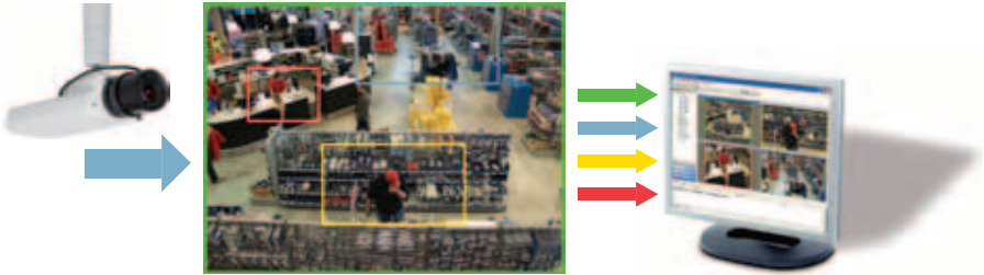
Figura 2.4e Una cámara multimegapíxel. Visión completa permitiendo áreas de visión cortadas. Vistas de múltiples cámaras virtuales (es posible disponer con hasta ocho vistas).
