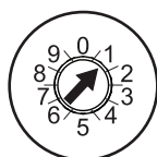
Figura 3.1: Interruptor de direcciones configurado en la dirección 1
