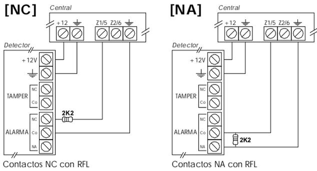
Zonas NC. Con Resistencia Final de Línea. Detección de dos alarmas (doblamiento zonas) y detección de Tamper / Avería en la misma zona.
