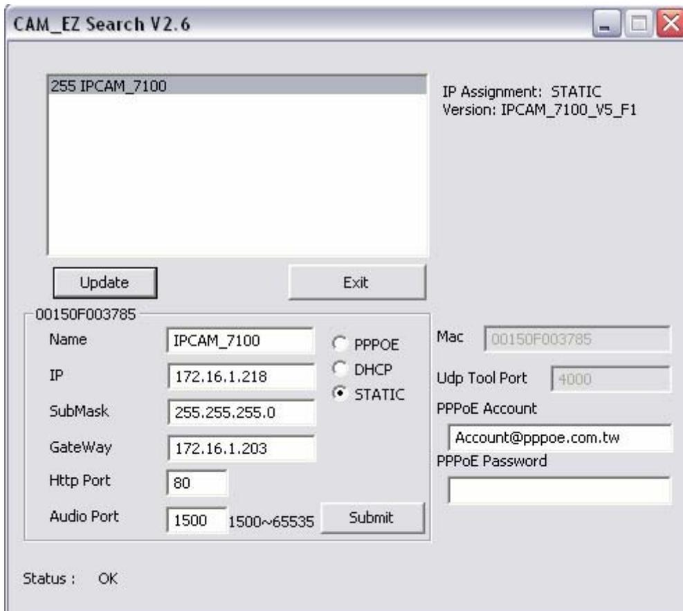
**IMPORTANTE:** El programa CAM\_EZ Search podrá detectar cualquier cámara en la red, esto NO significa que funcione si tiene distinto rango. En la imagen de ejemplo, si trabajáramos en una red configurada con una IP del rango 192.168.0.X no tendríamos acceso a esta cámara por estar en un rango de IP distinto.
