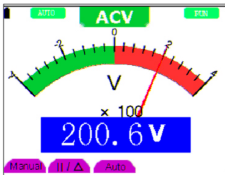
Figura 39: Medida de voltaje en Corriente Alterna.
