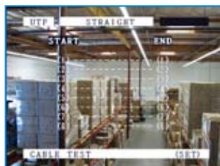
El **mapeador de hilos** para cableados UTP con presentación clara en pantalla de las condiciones de falla
