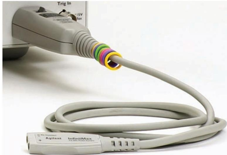
Figura 4. Numerosas sondas activas modernas utilizan interfaces de sondas inteligentes que proporcionan alimentación y actúan como enlaces de comunicaciones entre sondas compatibles y el osciloscopio.
