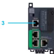
Los controladores lógicos Modicon **M251** disponen en su parte frontal de un puerto de conexión serie con un conector RJ45 que suministra 5 V/200 mA para alimentar una HMI Magelis, el adaptador de comunicación Bluetooth® u otros dispositivos.
