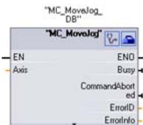
MC\_MoveJog ejecuta el modo jog para fines de test y arranque.
