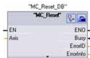
MC\_Reset resetea todos los errores de control de movimiento. Se acusan todos los errores de control de movimiento que pueden acusarse.
