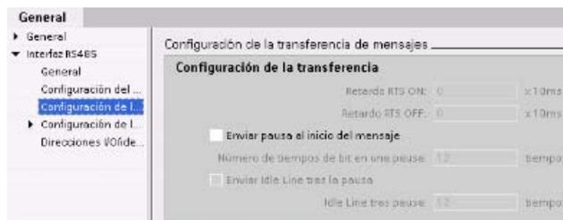
Durante la configuración del CM se ajusta cómo una interfaz de comunicación debe transmitir datos, definiendo la propiedad "Configuración de la transferencia de mensajes" para el CM seleccionado.
