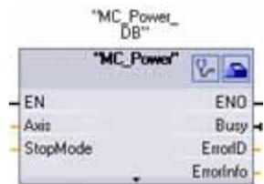
MC\_Power habilita e inhibe un eje de control de movimiento.
