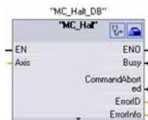
MC\_Halt cancela todos los procesos de movimiento y detiene el movimiento del eje. La posición de parada no está definida.
