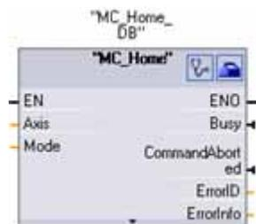
MC\_Home establece la relación entre el programa de control del eje y el sistema de posicionamiento mecánico del eje.
