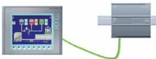
La CPU soporta conexiones PROFINET con dispositivos HMI. Los siguientes requisitos deben considerarse al configurar la comunicación entre CPUs y HMIs:
