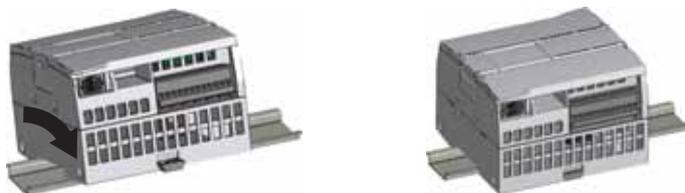
1. Monte el perfil DIN. Atornille el perfil al panel de montaje dejando un espacio de 75 mm entre tornillo y tornillo.
