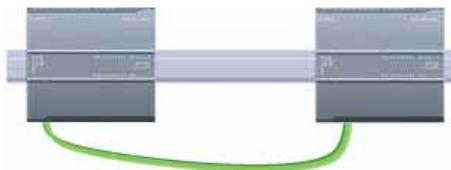
Conexión directa: Una CPU S7-1200 conectada a otra CPU S7-1200
