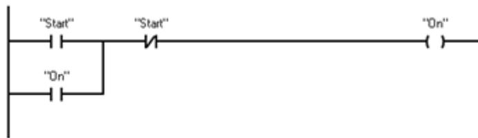
Los elementos de un esquema de circuitos, tales como los contactos normalmente cerrados y normalmente abiertos, así como las bobinas, se combinan para formar segmentos.
