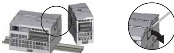
Retire la tapa del conector en el lado derecho de la CPU.
