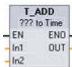
T\_ADD (Sumar tiempos) suma el valor de la entrada IN1 (tipos de datos DTL o Time) al valor Time de la entrada IN2. El valor DTL o Time resultante se deposita en el parámetro OUT.
