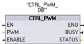
Dirección inicial: Introduzca la dirección de palabra Q en la que desea depositar el valor de la duración de impulso. La dirección predeterminada es QW1000 para PWM1 y QW1002 para PWM2. El valor de esta dirección controla el ancho del impulso y se inicializa al valor de la "Duración de impulso inicial:" indicado arriba cada vez que la CPU pasa de STOP a RUN. Este valor de palabra Q puede cambiarse en runtime para modificar la duración de impulso.
