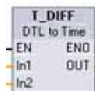
T\_DIFF (Diferencia de hora) resta el valor DTL de IN2 del valor DTL de IN1. La diferencia se deposita como tipo de datos Time en el parámetro OUT.
