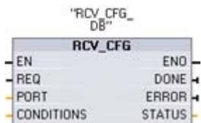
La instrucción RCV\_CFG (Recibir configuración) permite configurar dinámicamente los parámetros de recepción serie de un puerto de comunicación punto a punto. Esta instrucción configura las condiciones que indican el inicio y fin de un mensaje recibido. Todos los mensajes en cola de espera en un CM se rechazarán cuando se ejecute RCV\_CFG.
