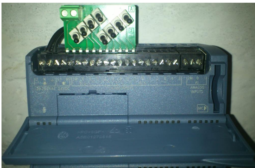
Figura 2. Tarjeta simuladora Siemens colocada en el PLC.
