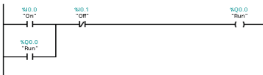
Figura 19. Circuito de autorretención terminado.
