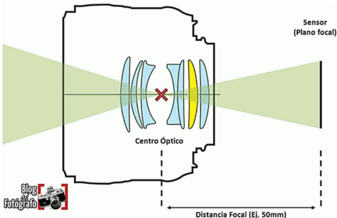
La **distancia focal de un objetivo** es la distancia que existe, expresada en milímetros, entre el sensor (plano focal) y el centro óptico de la lente.
