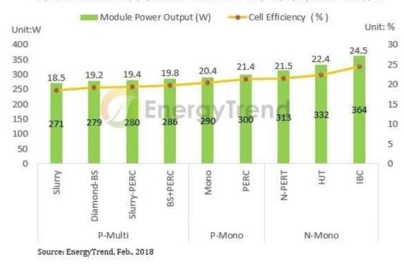
Como puede verse, es muy ilustrativo que los paneles solares más eficientes que existen en esa gráfica son los que incorporan las **tecnologías monocristalinas HIT e IBC, que usan silicio tipo N**. Es decir, Panasonic y SunPower fundamentalmente.
