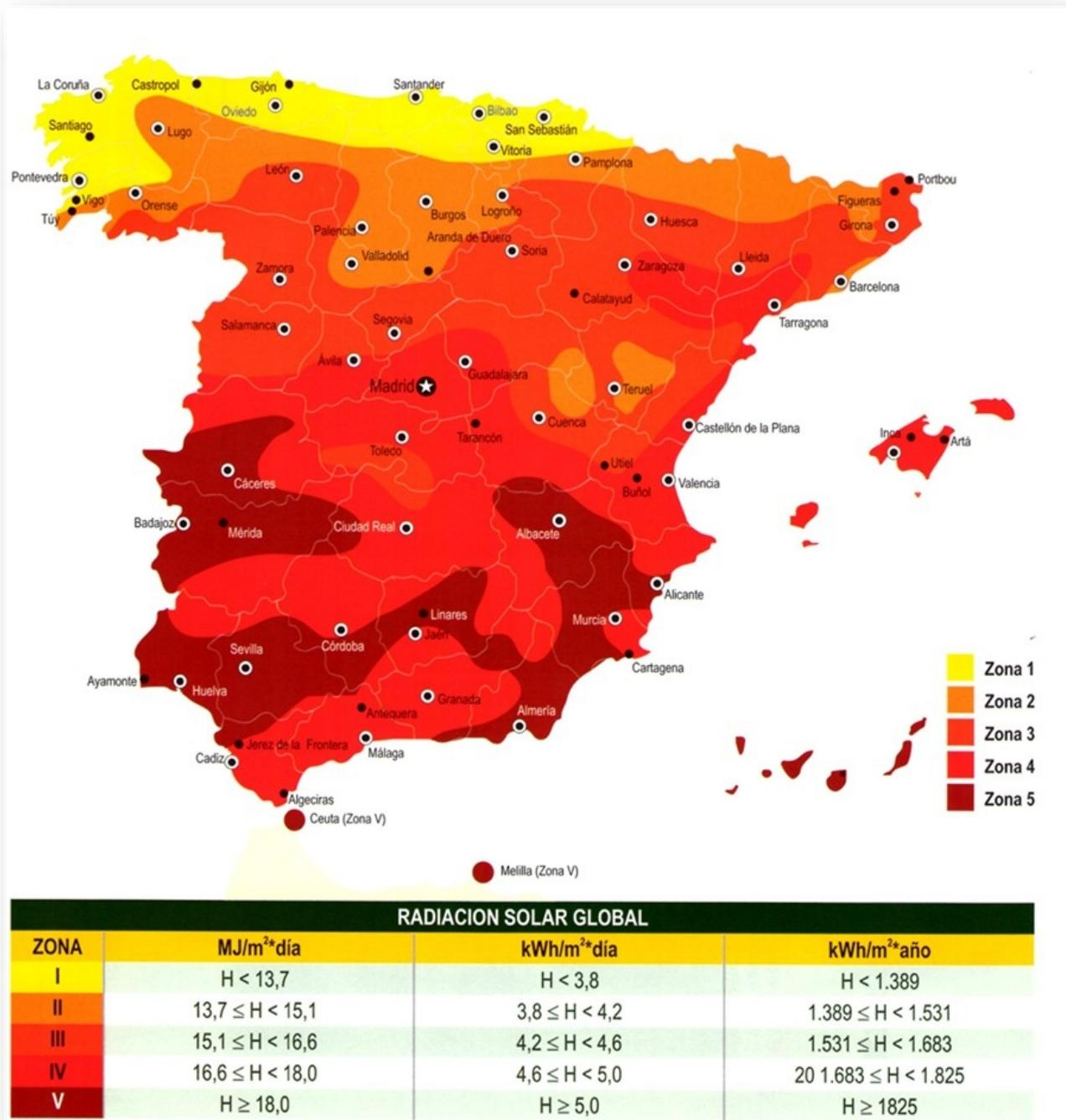
Veamos un caso práctico muy común con un consumo estimado de unos 3500Wh/día con utilización para todo el año. Con una potencia de paneles solares instalados de 1600Wp, lo que serían 5 paneles de 320W o 6 paneles de 270W tenemos las siguiente producción solar:
