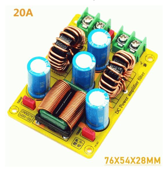
Características. Módulo de interferencia electromagnética de paso bajo 50V.
