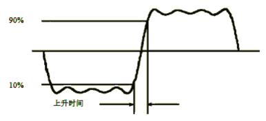
El tiempo de subida describe el rango de frecuencia útil de un osciloscopio.
