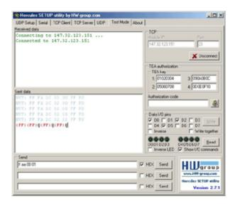
El modo de prueba está desarrollado para probar todas las funciones de los dispositivos Ethernet del grupo HW. De hecho, es solo un cliente TCP ampliado con algunas funciones más.
