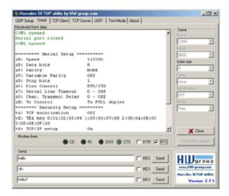
La pestaña Serie de la utilidad Hercules se puede utilizar como un terminal de puerto serie simple para el estándar RS-232. Es similar al Hyperterminal, algunas funciones ampliadas.
