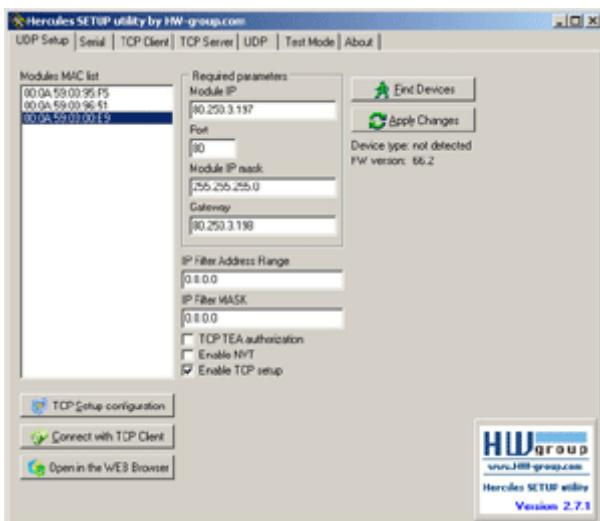
Esta pestaña se debe usar solo con dispositivos del grupo HW. En esta ventana puede asignar la dirección IP a los dispositivos compatibles (PortBox , PortStore , PortStore2 , I/O Controller , módulo Charon 1 , Poseidon , etc.)
