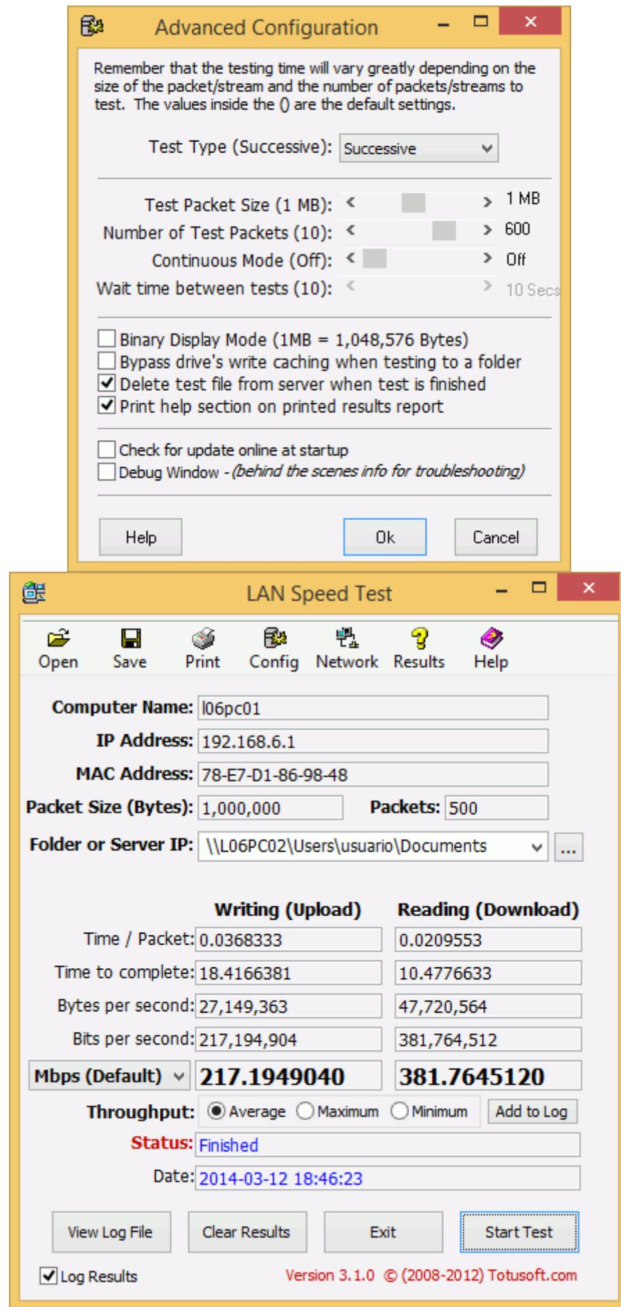
**Prueba con LAN Speed Test.** Se recuerda que la prueba debe realizarse entre dos equipos diferentes, debiendo mostrarse las tres capturas de pantalla y añadiendo la siguiente documentación:
