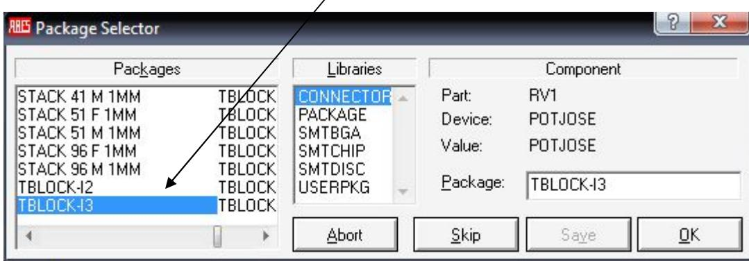
Y si tienes tres o cuatro potenciómetros ese letrero te saldrá varias veces hasta que se los coloques a todos.
