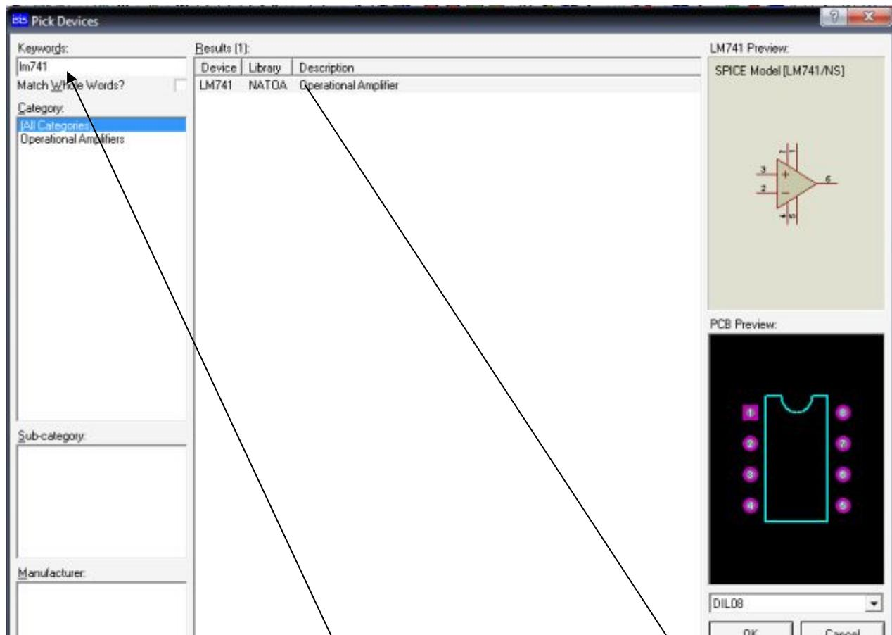
Si te das cuenta coloco LM741 en en keywords, y aparece enseguida, solo basta con que des doble click aqui
