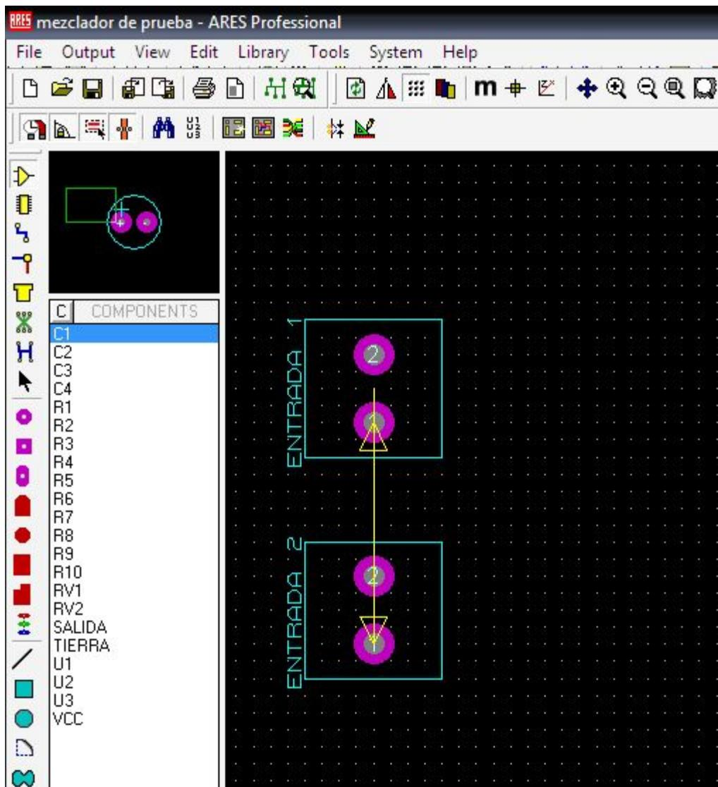
Y automáticamente te empiezan a aparecer las conexiones, debes ir colocando los elementos de acuerdo al diagrama, que los componentes que sean cercanos como por ejemplo... en el diagrama del mezclador cerca del conector de entrada 1 esta el C1 y la R1
