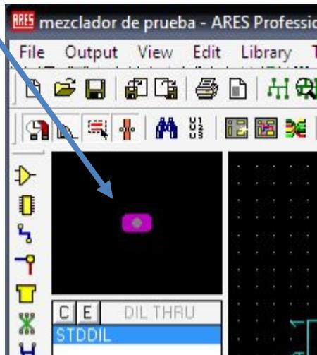
Y ahora si lo puedes colocar en la resistencia jeje. Para condensadores puedes aumentarle el tamaño solo un potito porque si no se pegan y te va a arrojar un error.
