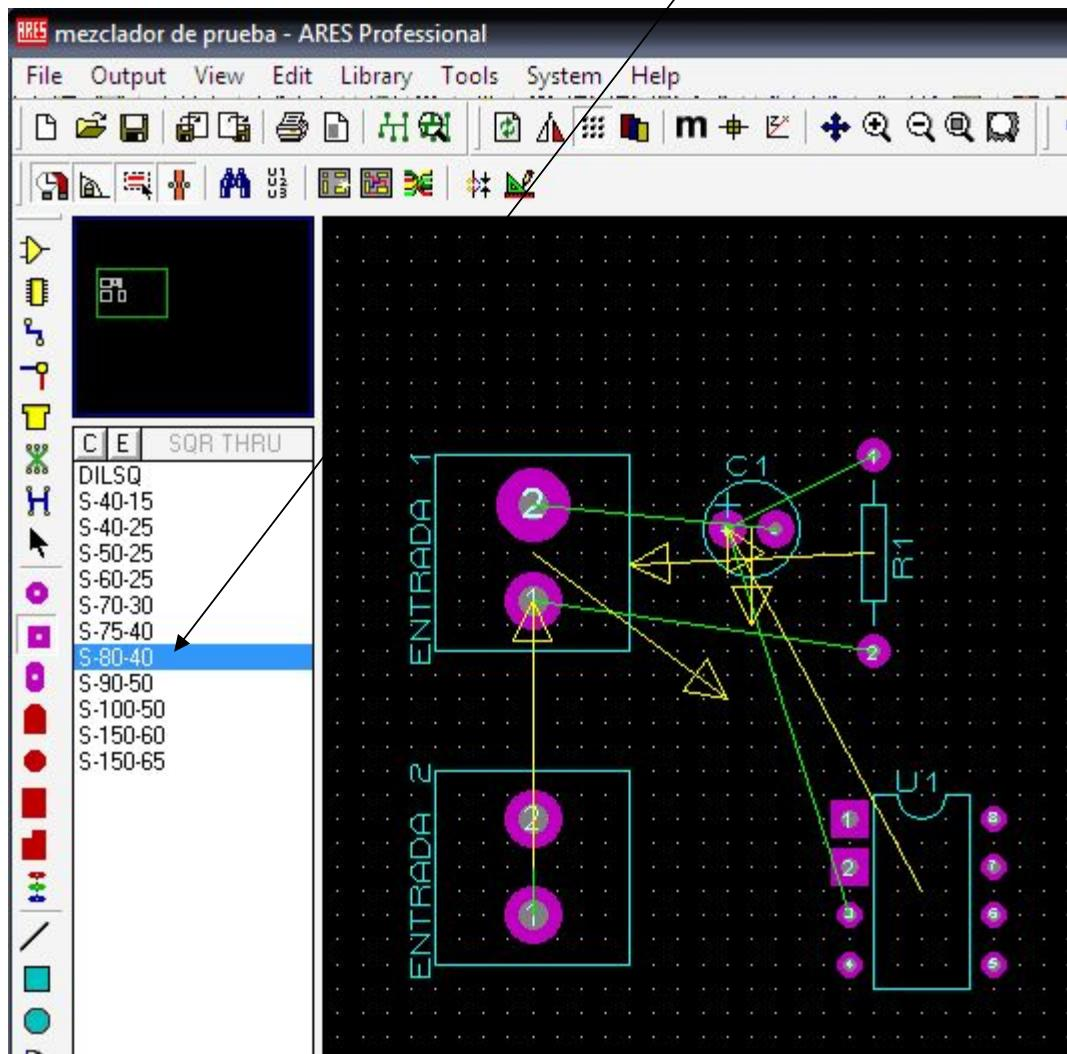
Y para las resistencias utilizas este pad, solo tiene una sola medida asi que no hay problema.
