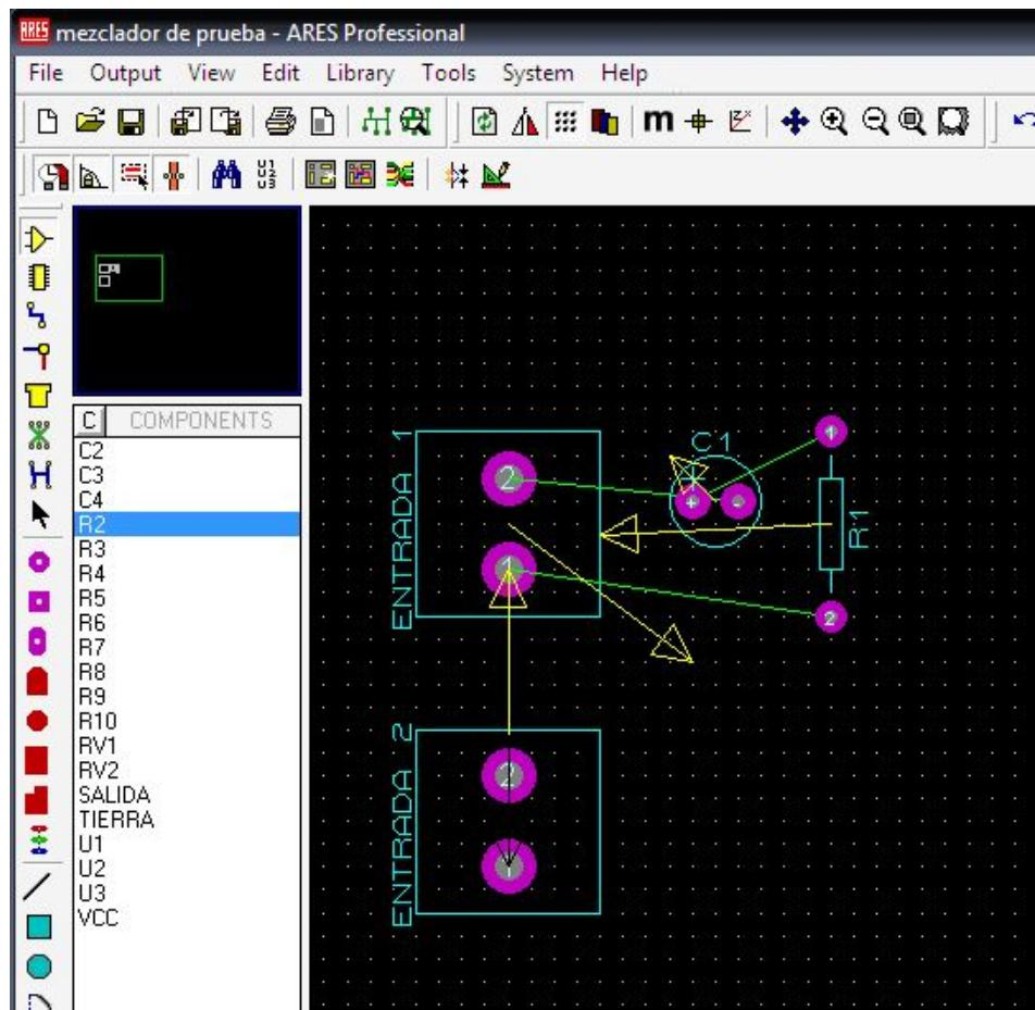
A medida que vayas colocando los elementos en la board ellos desaparecerán de la lista... mira que los conectores de entrada1, entrada 2, el C1 y la R1 ya no aparecen en la lista... (Para colocar los componentes en la parte negra solo lo señales en la lista y das click en la board y ellos aparecen allí automáticamente)
