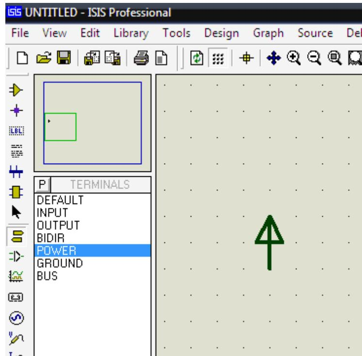
Para explicarte mejor... mira si tienes un circuito con solo Vcc y tierra y necesitas que de un conector de bornera para alimentar el circuito, y tienes ese diagrama demasiado enredado lleno de conexiones puedes hacer esto...
