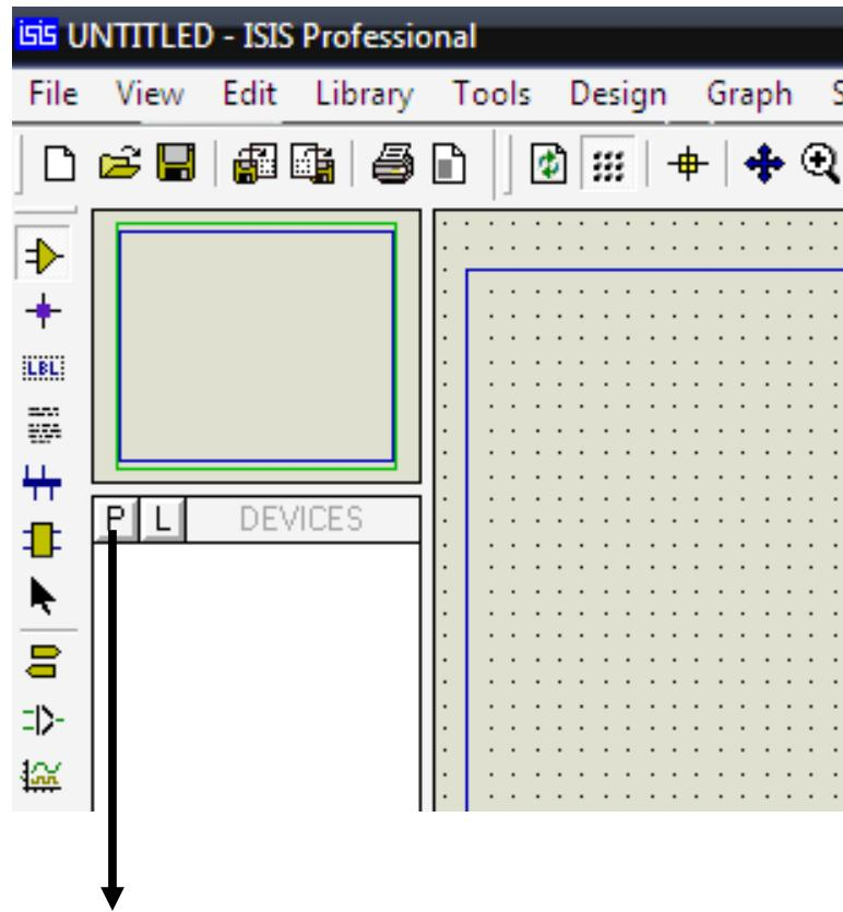
En esa "P" están todos los componentes que necesites para hacer un circuito... (resistencias, condensadores, reles..etc.). Le das click y te aparece este panel...que se llama PICK DEVICES
