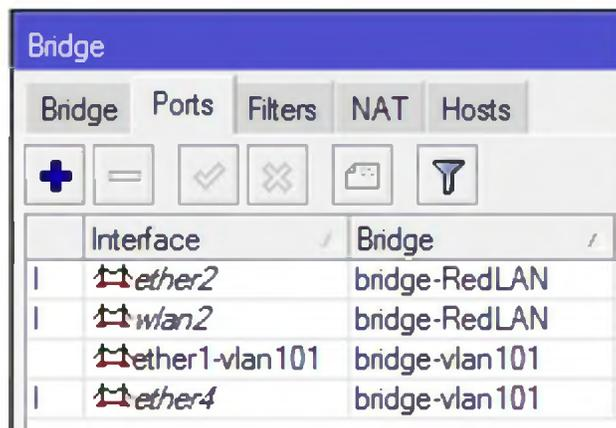
De esta forma conectamos nuestra computadora en el puerto "ether4", obtendrá dirección IP dentro del segmento de Red de la VLAN.
