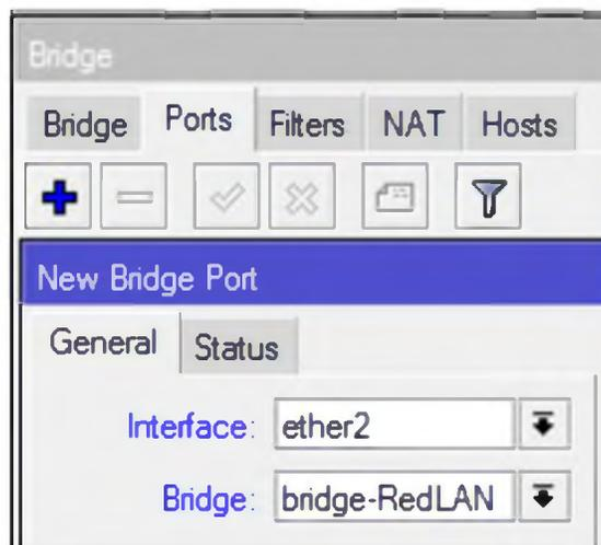
Obteniendo un registro donde nos indica que nuestro puerto físico "ether2" es parte de una interface virtual de tipo Bridge con el nombre "bridge-RedLAN"
