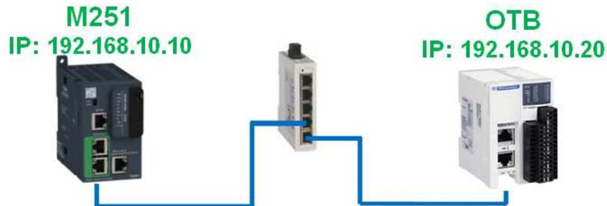
La isla advantys OTB, tiene integradas **12 entradas y 8 salidas** digitales, las cuales están direccionadas en los registros **0000 (entradas) y 0100 (salidas)**.
