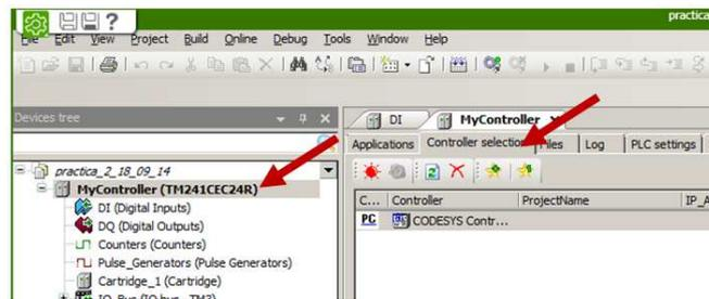
Inicialmente se tiene que tener conectado con el cable de programación el PC al controlador (cable de programación **USB - Mini USB** para los controladores M238, M241, M251, M258, LMC058 y ATVIMC para las pantallas XBTGC el cable será el XBTZG935). Para acceder añadir un Gateway, hacer doble clic sobre el controlador en la ventana de dispositivos y en el área de trabajo aparece las diferentes pestañas de configuración del controlador, en esta seleccionar la pestaña '**Controller selection**'.
