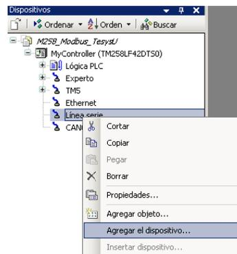
Añadir el elemento 'Modbus IO Scanner' de la lista de equipos a la 'Línea Serie 1'.
