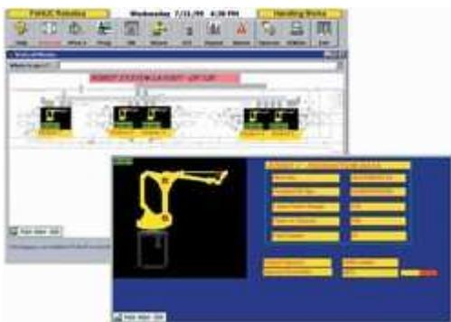
HandlingWorks es una software de redes que permite a los usuarios monitorizar un sistema con un robot RJ3 de forma remota desde un PC. Proporciona un interface simple y gráfico que permite controlar la producción diaria y mantenimiento en robots RJ3.
