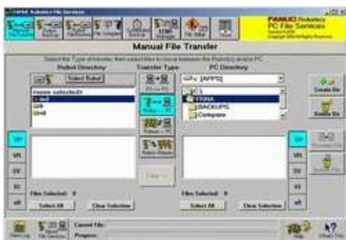
Software PC File Services FANUC Robotics (para Microsoft Windows NT y Windows 2000) proporciona una capacidad de manejo fácil para transferencia de archivos para FANUC Robots. Permite al usuario realizar la salvaguarda o restauración de los archivos de aplicación y/o programas del robot desde un PC vía Ethernet. El software PC File Services utiliza el Protocolo File Transfer Protocol
